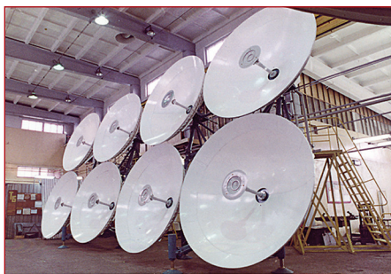
Фазированная антенная решетка зеркальных антенн
