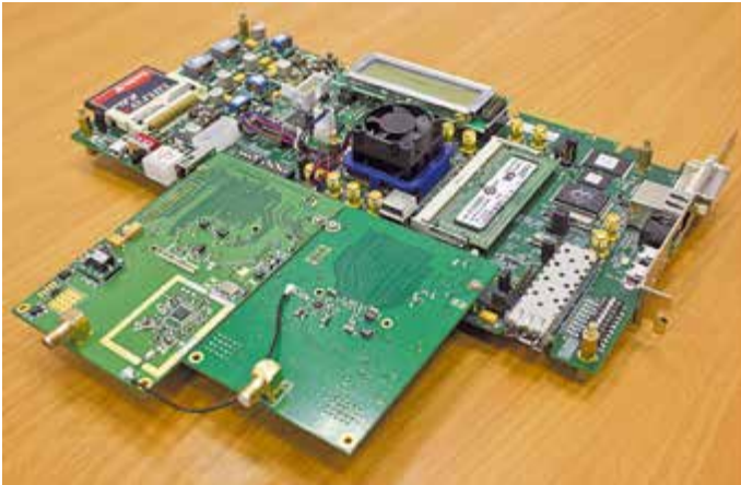
Рис. 6. Аппаратная платформа имитатора — отладочный комплект Xilinx ML605 Development Kit и две платы с АЦП и ЦАП производства ООО «РТС», г. Ярославль
