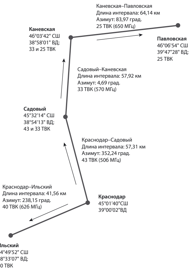
Рис. 6. Топология транспортной сети доставки ТВ-мультиплекса на базе объектов филиала РТРС Краснодарского РТПЦ
