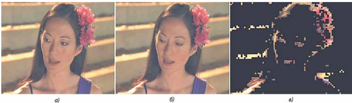
Рис. 2. Компенсация движения на основе перемещения блоков
