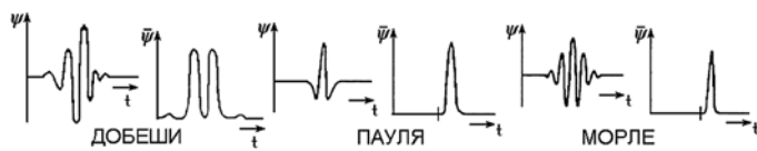
Рис. 6. Наиболее распространенные вейвлет-функции для обработки изображений
