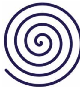
Рис. 2. Топология индуктивности на основе спирали Архимеда
