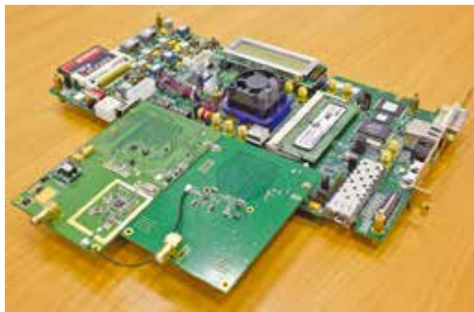
Рис. 2. Отладочная плата ЦОС Xilinx ML 605 с модулями АЦП и ЦАП
