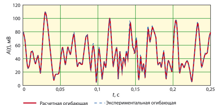
Рис. 8. Теоретическая огибающая сигнала на выходе канала и огибающая сигнала, полученная экспериментально на выходе имитатора
